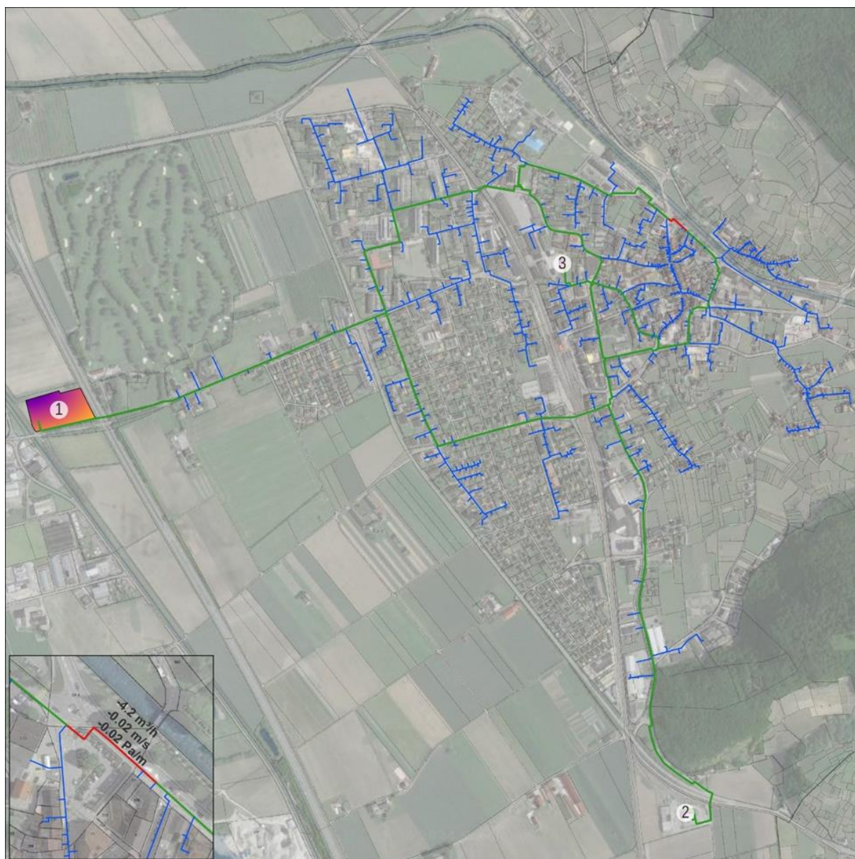
Figure 56 : Scénario 2 – Branches « mortes »
