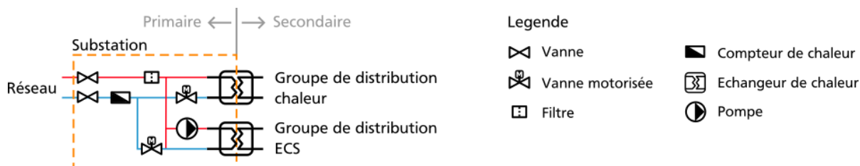
Figure 7 : Sous-station type 2 avec deux échangeurs de chaleur.
