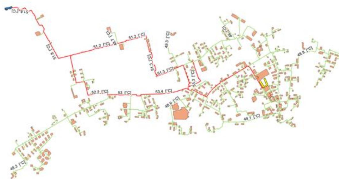
Figure 39 : Tracés influencés par le fonctionnement de la sous-station CM1203 (en rouge) La centrale de chauffe est figurée en bleue et la sous-station en jaune
