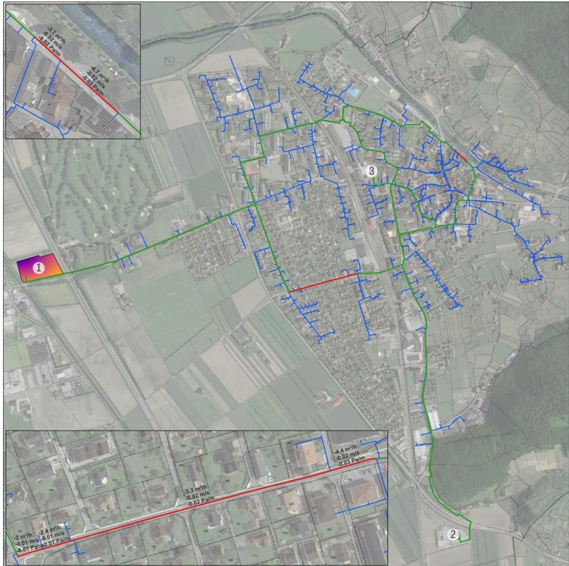
Figure 62 : Scénario 5 – Branches « mortes »
